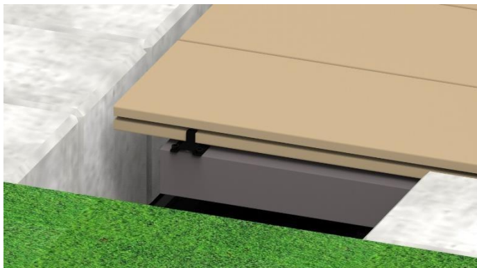
Bild 28. Wenn die letzte WPC-Deile mit dem Anfangs-/Endclip befestigt werden soll, muss die Unterkonstruktion ca. 10 – 13 mm über die letzte WPC-Deile vorstehen.
