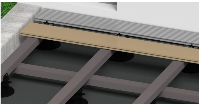
Bild 21. Wenn alle Anfangsclips montiert worden sind, wird die erste WPC-Diele auf den Clip geschoben.
