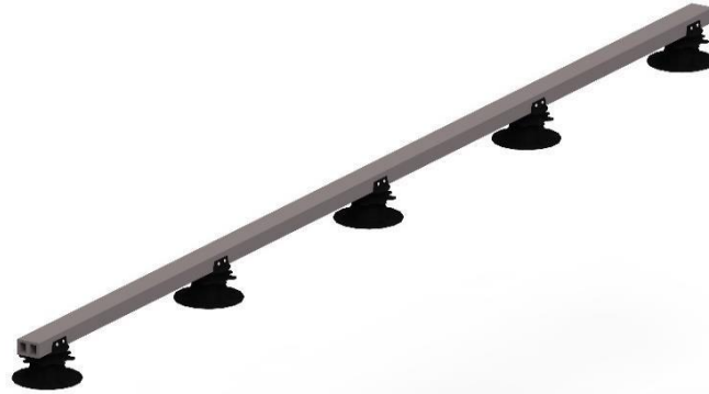
Bild 5. Die Verstellfüße müssen mit einem maximalen Achsmaß von 600 mm an die WPC-Unterkonstruktionen geschraubt werden.
