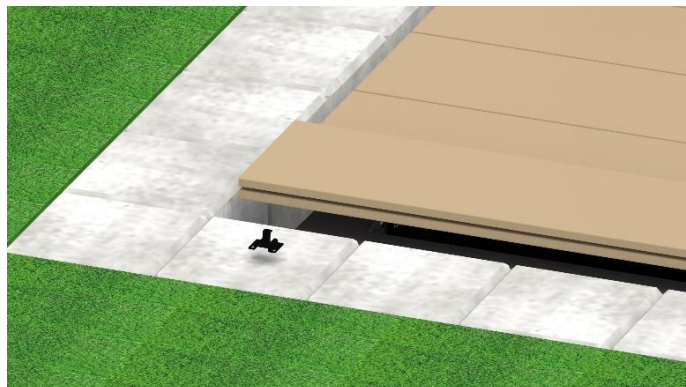
Bild 29. Bevor die letzte WPC-Deile eingesetzt wird, müssen alle Anfangs-/Endclips auf die WPC-Deile gesteckt werden.
